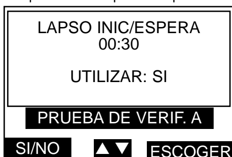
Figura 84. Pantalla de visualización de la selección de lapso inicial de espera de la prueba de verificación.
