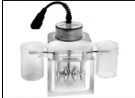
Figure 36. Cuve d'essai d'huile pour la spécification ASTM D1816
