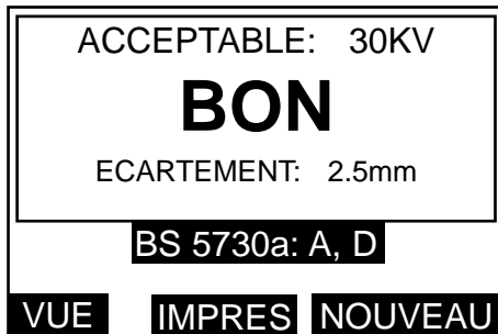
Figure 44a. Ecrans d'affichage satisfaisant. (BON) et insatisfaisant (DE FAUT) de l'essai BS5730a
