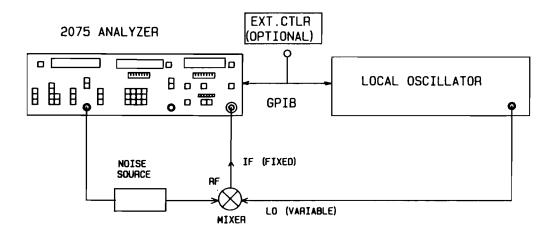
Figure 3-7a. TEST CONFIGURATION 2 CALIBRATION (DOUBLE SIDEBAND)
