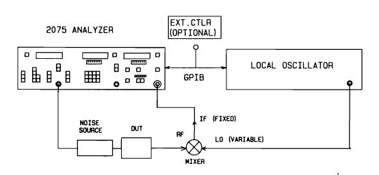
Figure 3-7b. TEST CONFIGURATION 2 MEASUREMENT (DOUBLE SIDEBAND)
