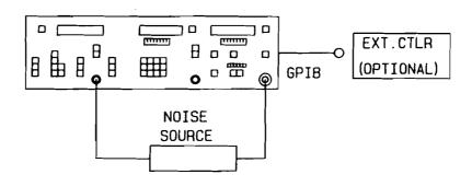
Figure 3-10a. TEST CONFIGURATION 4 CALIBRATION (DOUBLE SIDEBAND)
