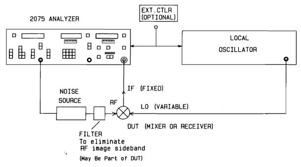
Figure 3-11b. TEST CONFIGURATION 4 MEASUREMENT (SINGLE SIDEBAND)
