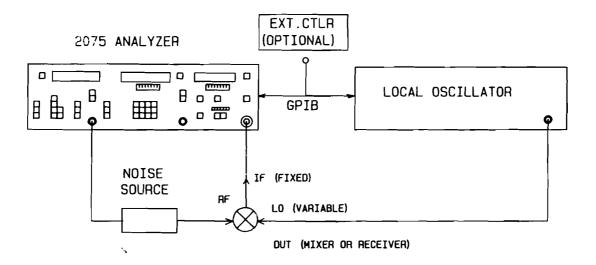
Figure 3-10b. TEST CONFIGURATION 4 MEASUREMENT (DOUBLE SIDEBAND)
