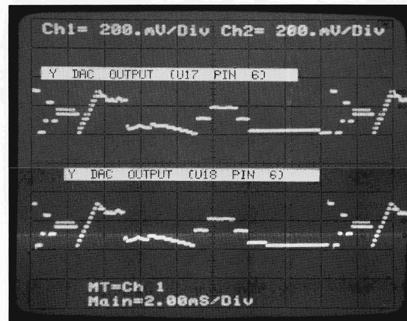
TOP: Y DAC OUTPUT A1 U17 PIN 6 BOTTOM: Y DAC OUTPUT A1 U18 PIN 6
