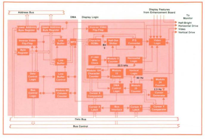
Fig. 3. 2640A display subsystem.
