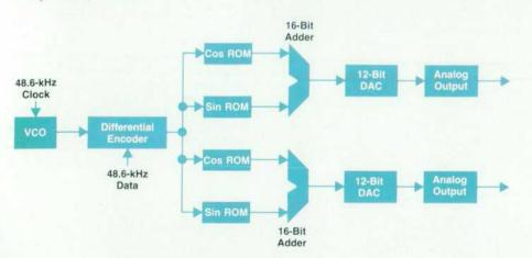
**Fig. 1.** HP 11846A π/4 DQPSK generator block diagram.
