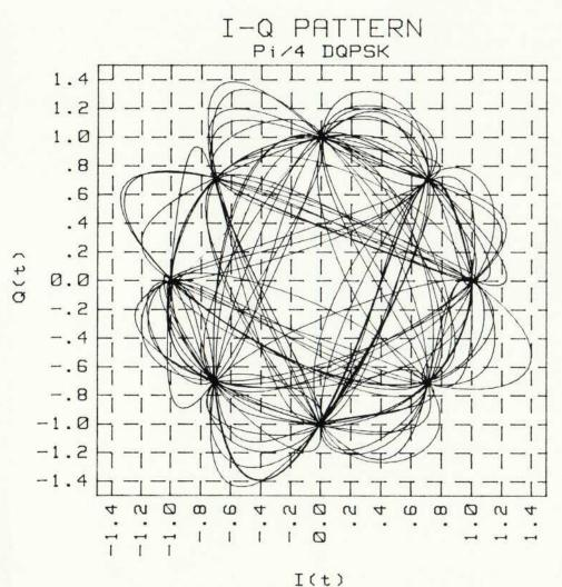
**Fig. 7.** A typical π/4 DQPSK I-Q diagram.
