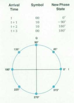
Fig. 5. I-Q diagram of m/4 DQPSK modulation.
