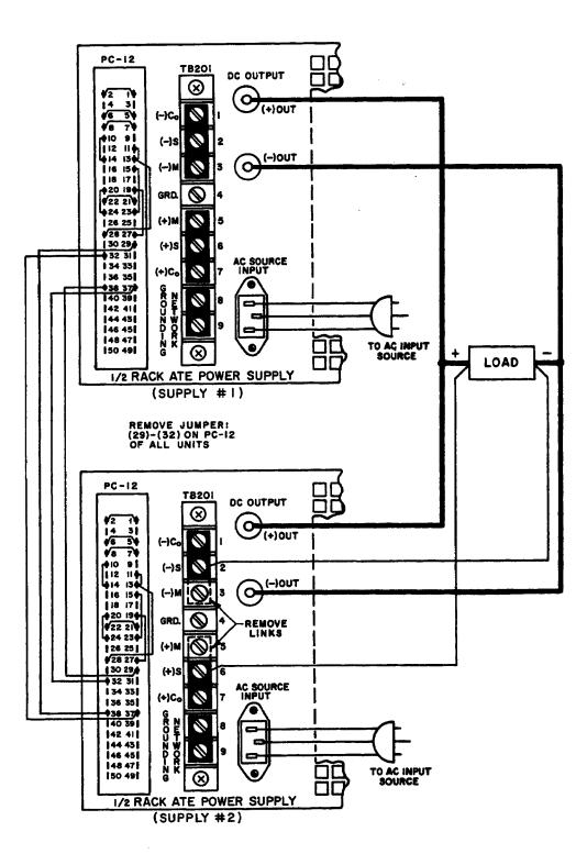
FIG. 3-25 CONNECTIONS FOR AUTOMATIC PARALLEL OPERATION.
