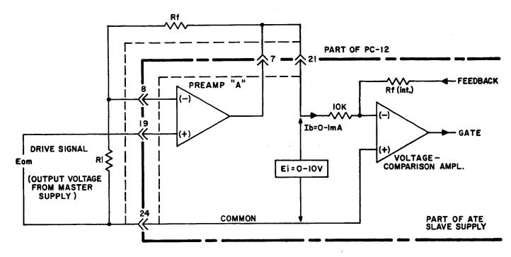
FIG. 3-23 DEVELOPING THE DRIVE FOR THE MASTER/SLAVE SERIES CONNECTION FOR 6V ATE SUPPLIES.
