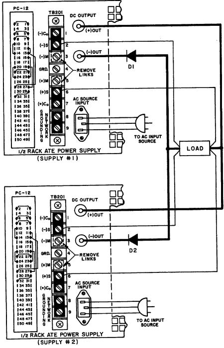
FIG. 3-28 REDUNDANT PARALLEL CONNECTION WITH ATE POWER SUPPLIES.
