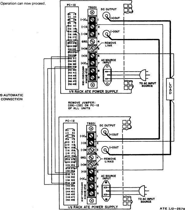
FIG. 3-20 AUTOMATIC SERIES CONNECTION
