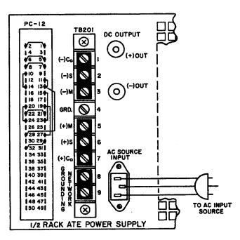
FIG. 3-2 STANDARD JUMPER LINK CONNECTIONS FOR LOCAL (FRONT PANEL) CONTROL OF THE OUTPUT VOLTAGE, OUTPUT CURRENT AND VP CROWBAR LEVEL (SLOW MODE).
