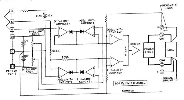
FIG. 3-23 LOCAL (FRONT PANEL) CONTROL OF THE BOP VOLTAGE LIMIT CIRCUITS
