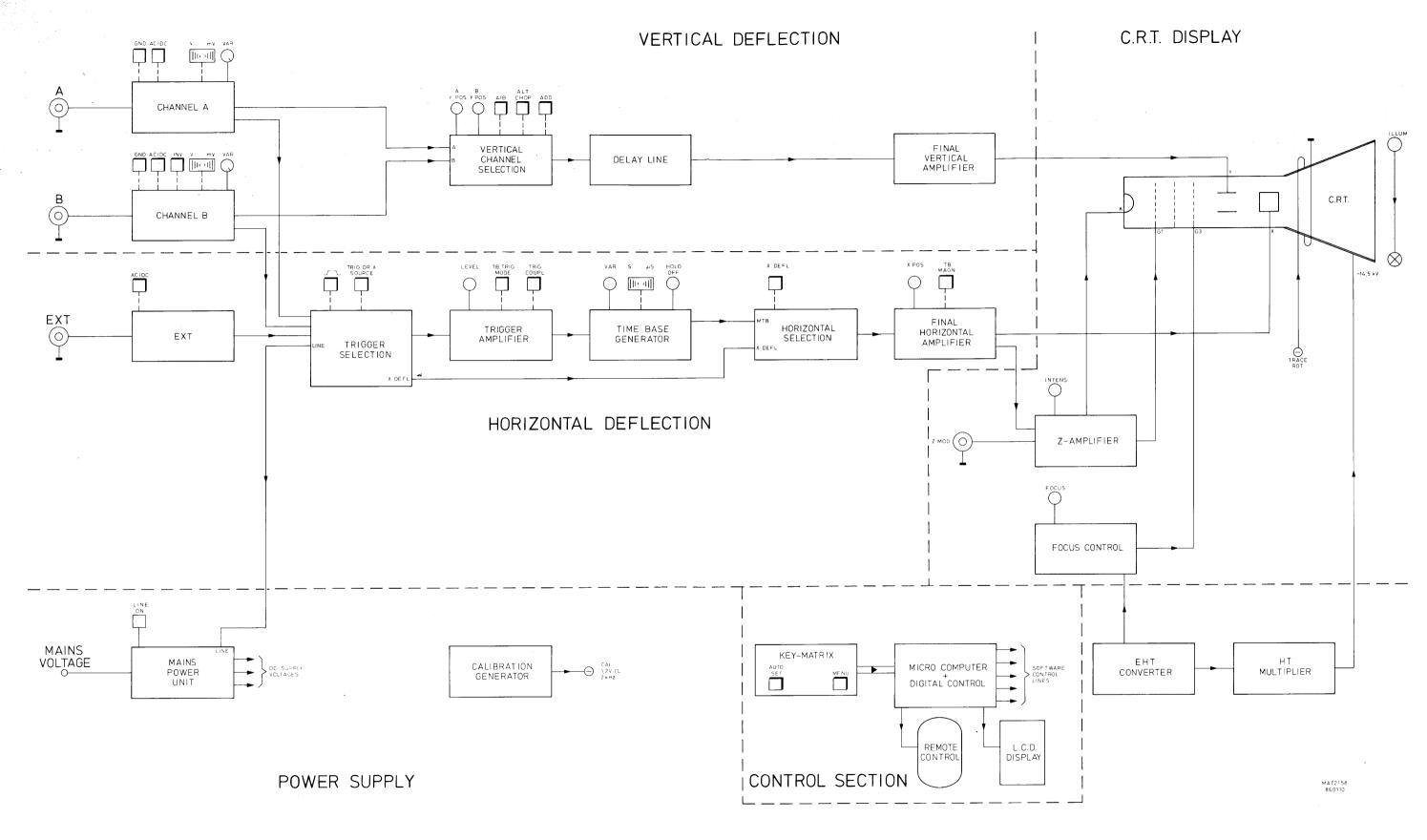
Block diagram Blockdiagramm Schéma par blocks
