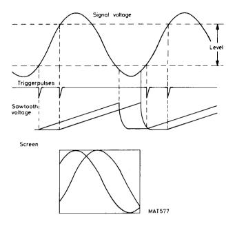
**LEVEL** : Der LEVEL-Einsteller dient zur Festlegung des Startpunktes der Zeitbasis. Die Zeitbasis startet, sobald das Triggersignal den Spannungspegel des LEVEL-Einstellers erreicht hat.
