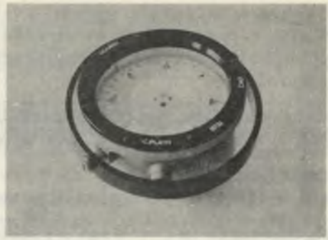
Rys. 9. Kompas łodziowy bez obudowy /szafki/
