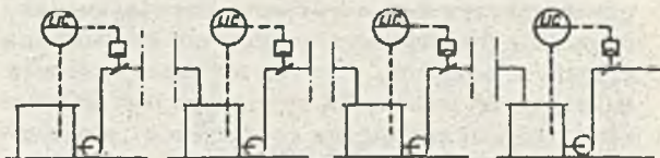
Rys. 4. Stabilizacja przepływu soku
