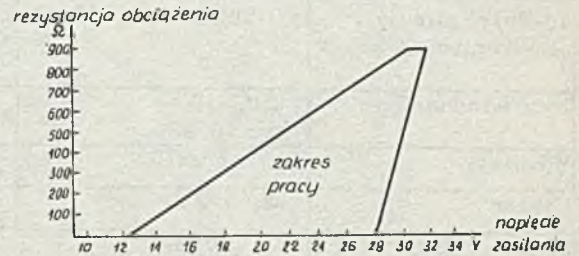
Rys. 14. Dopuszczalna rezystancja obciążenia
