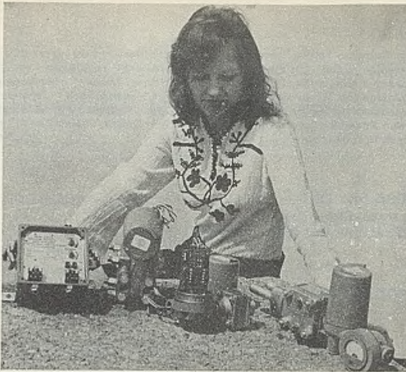
Fot. 1. Przetworniki ciśnienia systemu EFTRONIK - od lewej: międzysystemowy A271, różnicy małych ciśnień klasy 41, ciśnienia klasy 41, różnicy średnich ciśnień z miernikiem wyjściowym
