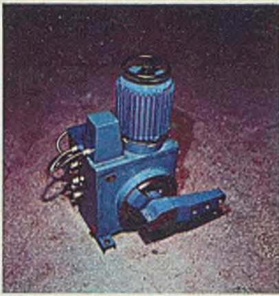
Siłownik elektryczny napędzany silnikiem skokowym — nowoczesny element wykonawczy w komputerowych systemach automatyzacji
