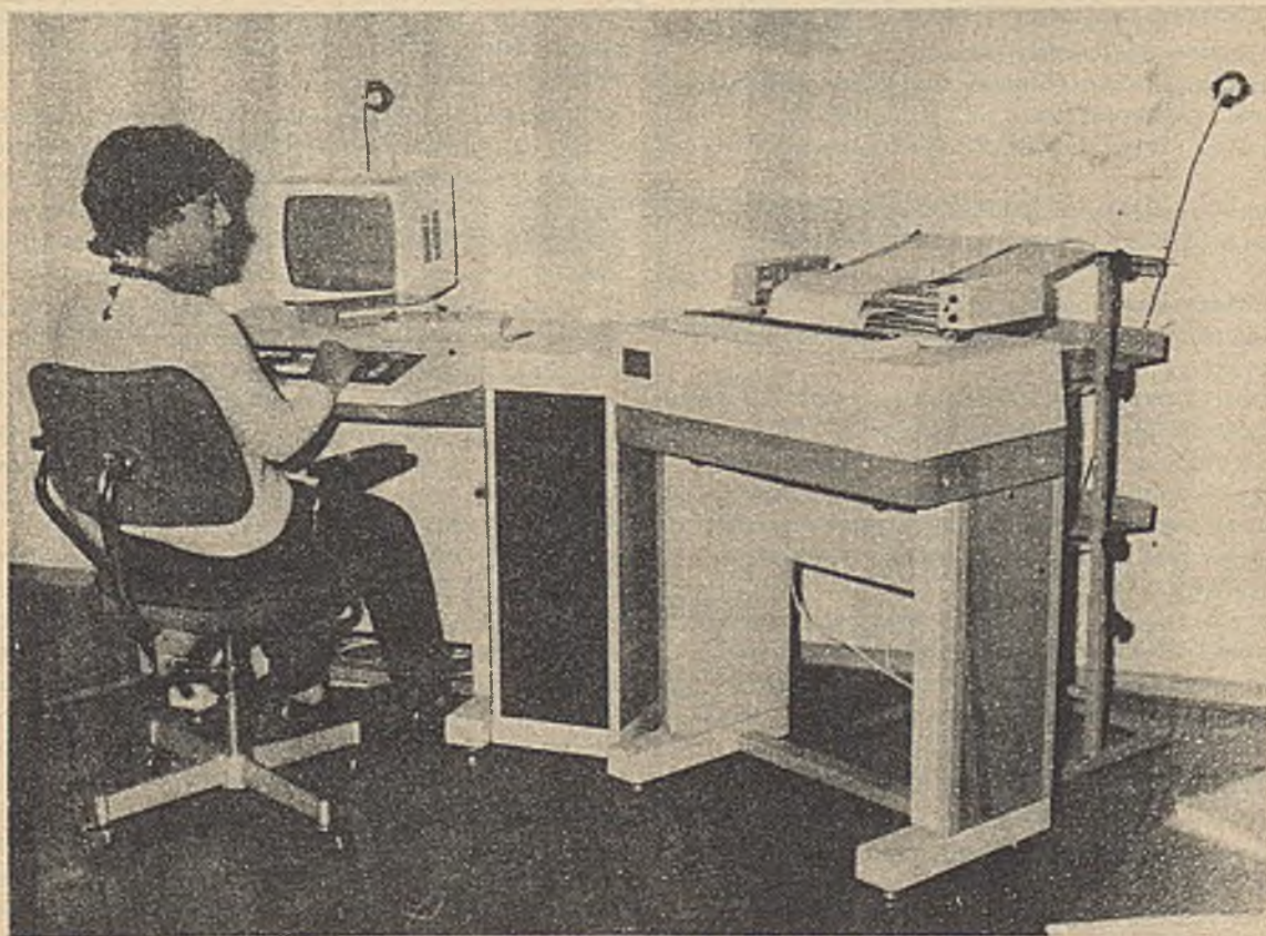
Fot. 1 Programowana stacja gromadzenia i wstępnego przetwarzania danych typu PSPD90
