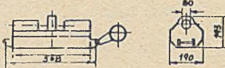
GP-2 Średnice lin 10 do 60 mm. Średnice cewek pom. 80 i 115 mm. Masa 46 kg.
