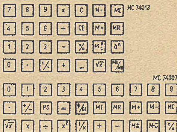
Rys. 1. Klawiatura przystosowana do współpracy z układami kalkulatorowymi MC 74007 MC 74013
