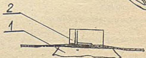
Rys. 5. Głowica podwójna niesymetryczna: 1-głowica sztywna, 2-głowica elastyczna, 3-element zawieszania
