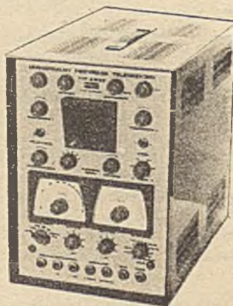
Fot. 2a. Pierwszy uniwersalny przyrząd telewizyjny, produkowany w połowie lat 60-tych.
