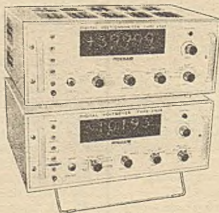
Fot. 2. Cyfrowe woltmierz kompensacyjne, produkowane w pierwszej połowie lat 70-tych
