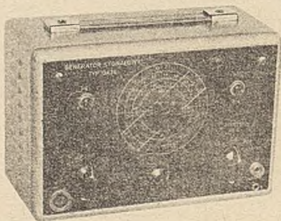
Fot. 1a. Lampowy miliwoltomierz / 700MHz / produkowany na przełomie lat 1960-70
