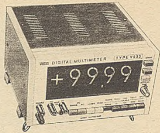
Fot. 3. i 3a. Pierwsze konstrukcje wykonane techniką obwodów scalonych - produkcja w pierwszej połowie lat 70-tych
