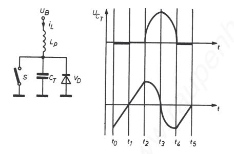
Bild 11 Ersatzschaltung für die Hochspannungserzeugung
