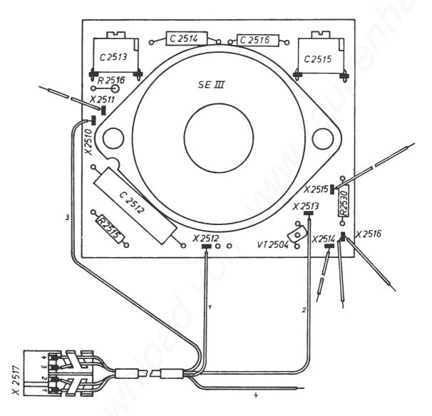
Bild 17: Leiterplatte kompl. Kippstufenschalter III
