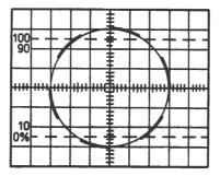
Bild 10 Oszillogramm einer helligkeitsgesteuerten kreisförmigen Zeitbasis
