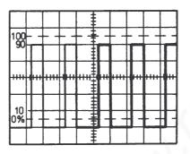
Bild 6 Oszillogramm eines Rechtecksignals mit einer Frequenz f = 10 kHz und einer verzögerten Auslösung der Zeitablenkung von 0,2 ms im Suchbetrieb
