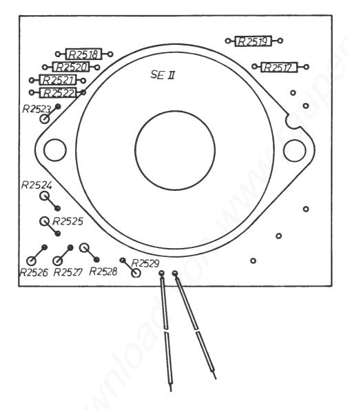
Bild 16: Leiterplatte kompl. Kippstufenschalter II
