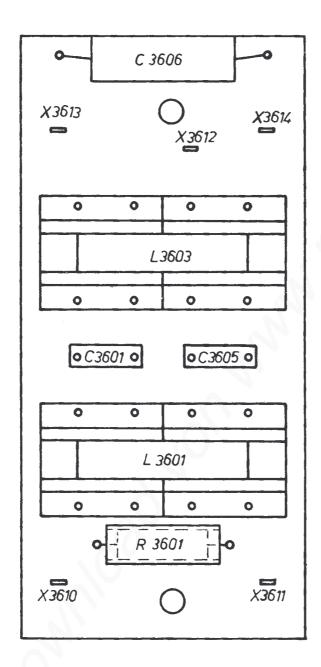
Bild 6: Leiterplatte kompl. Entstörleiterplatte
