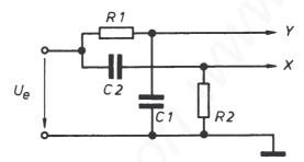
Bild 9 Einfachste Schaltung zur Erzeugung einer kreisförmigen Zeitbasis
