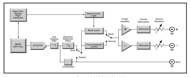
Figure 2-1 DS360 Block Diagram
