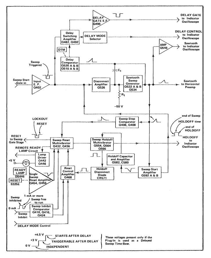
Fig. 3-6. Sweep Generator Block Diagram.
