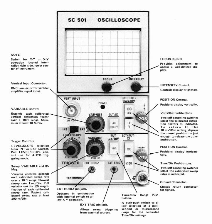
Fig. 1-2. CONTROLS & CONNECTORS.
