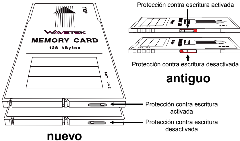
Fig. 7.12: En la posición correcta, el interruptor de protección contra escritura protege los ficheros en una tarjeta de memoria de forma segura contra borrado o sobreescritura accidental. La disposición del interruptor de corredera en la tarjeta de memoria es diferente en la versión nueva (izquierda) y la antigua.
