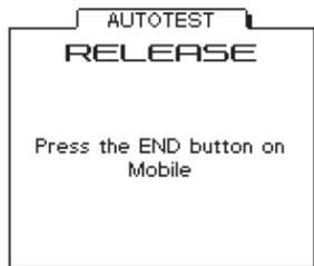
**2. Eingabe** Wurde der AUTOTEST nicht wegen eines Fehlers am Mobiltelefon abgebrochen, erfolgt ein erneuter Stopp unmittelbar vor dem Test des korrekten Verbindungsabbaus (Auflegen am Mobiltelefon).
