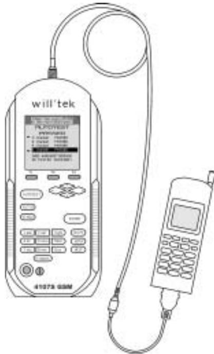
*Kabelgebundene Ankopplung des Prüflings ist für Präzisionsmessungen die beste Wahl.*
