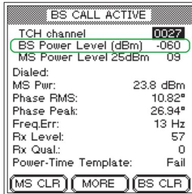
Dieser Test simuliert die raue Wirklichkeit: Mit zunehmender Entfernung zur Basisstation sinkt am Mobiltelefon der HF-Empfangspegel. Bis mindestens  $-102$  dBm Empfangspegel sollte ein Handy die Verbindung störungsfrei aufrecht erhalten können (Autotelefone:  $-104$  dBm) – so verlangt es die GSM-Spezifikation.
