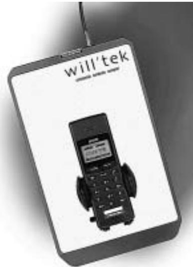
*Beim Universal-Antennenkoppler kommt es darauf an, Mobiltelefone eines Typs immer in derselben Position zwischen den Halteklammern zu platzieren.*
