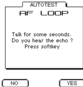
**4. Eingabe** Wurde der AUTOTEST nicht wegen eines Fehlers am Mobiltelefon abgebrochen, stoppt er ein letztes Mal beim Sprechtest. Dieser Test ist nur dann erfolgreich, wenn alle NF-/HF-Baugruppen im Sende- und Empfangszweig des Mobiltelefons einwandfrei sind.
