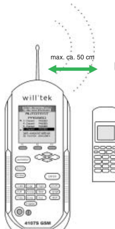
*Drahtlose Ankopplung des Prüflings über Antenne. Die Ausrichtung beider Antennen zueinander ist ohne große Bedeutung.*
