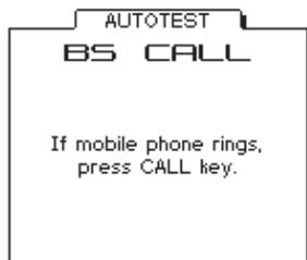
**3. Eingabe** Wurde der AUTOTEST nicht wegen eines Fehlers am Mobiltelefon abgebrochen, fordert der Tester beim erneuten Verbindungsaufbau (diesmal BS CALL) zur Entgegennahme des Anrufs (kommend vom Tester) auf.
