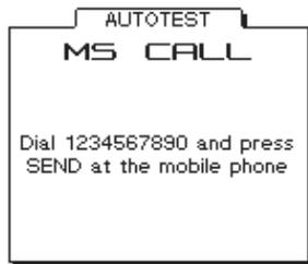
**1. Eingabe** Beim Verbindungsaufbau (MS CALL) fordert der Tester zur Eingabe einer bestimmten Rufnummer am Mobiltelefon auf.
