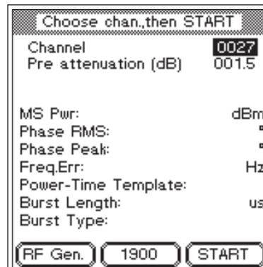
Softkey (1900) wird nur dann angezeigt, wenn ein Multiband-Funksystem ausgewählt wurde.
