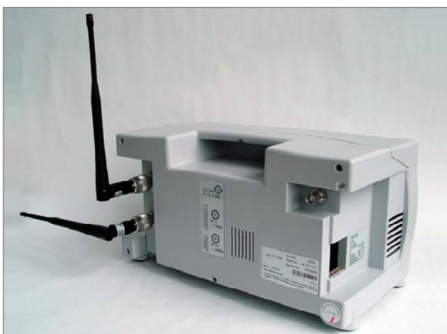
图3：从4208的后视图可以看到，它采用了单独的射频输入和输出连接器。通过让两个天线保持90度的夹角，可以进一步隔离接收路径和发射路径。
