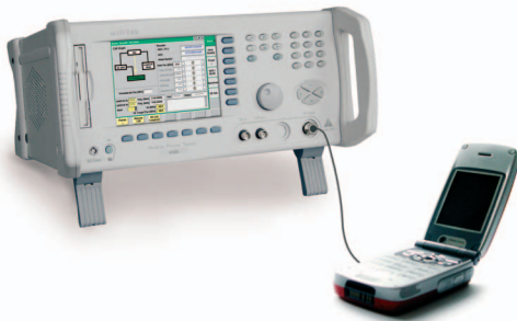
Abbildung 2: Messaufbau-Varianten für den Endtest eines 3G-Mobiltelefons
