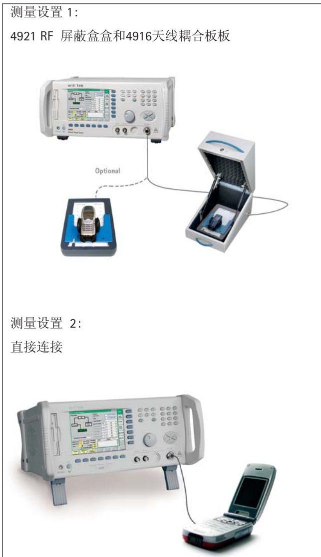
图 2: 对TD-SCDMA无线终端进行最终测试的测量设置方式
