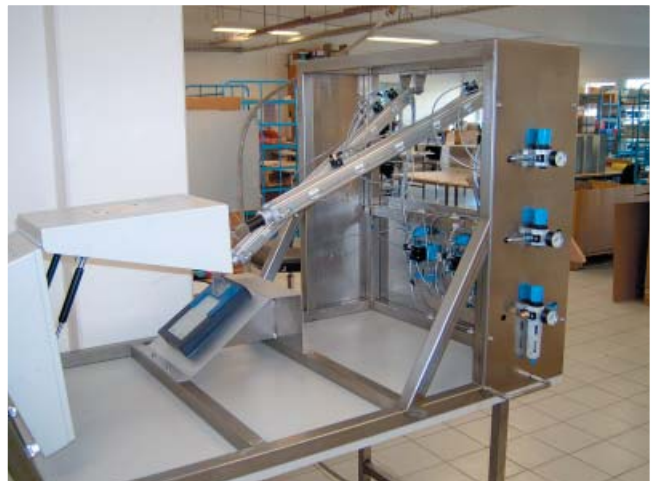
4921射频屏蔽盒在进行机械寿命测试
