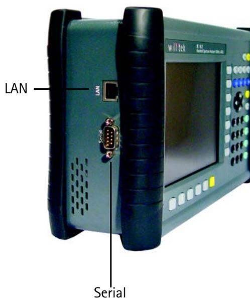
Abb. 3 9100-Anschlüsse auf der linken Seite des Messgerätes
