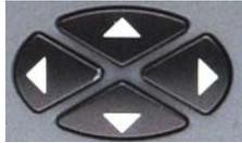
In einem Eingabefeld lässt sich mit Hilfe der nach oben und nach unten gerichteten Cursor-Tasten der aktuelle Wert erhöhen und reduzieren. Mit den beiden anderen nach links und nach rechts gerichteten Cursor-Tasten können Sie den Cursor um eine Stelle versetzen.
