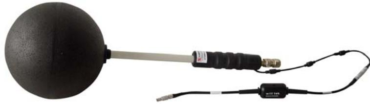
Die bequemste und schnellste Lösung für die Durchführung von EMV-Immissionsmessungen bildet die Messanordnung mit einer isotropen Antenne. In einer isotropen Antenne sind drei Antennen (oder Dipolelemente), eine für jede Richtung (x, y und z), orthogonal angeordnet und zusammengeschaltet. Die folgende Grafik zeigt dieses Aufbauprinzip einer isotropen Antenne.
