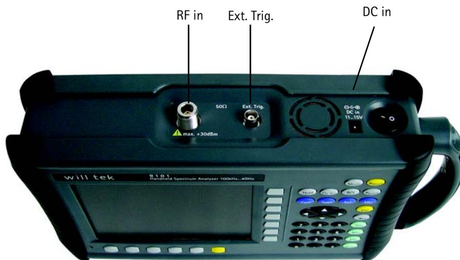
Abb. 1 9101-Anschlüsse auf der Oberseite des Messgeräts
