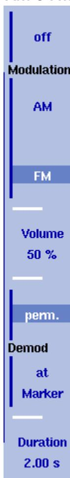
El 9101 tiene la capacidad de demodular una señal de AM (modulación de amplitud) o de FM (modulación de frecuencia) e inyectar la señal resultante en el altavoz integrado en el equipo. La señal deberá tener una potencia de al menos -50 dBm y el ancho de banda de demodulación es de unos 10 kHz.
