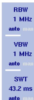
El ancho de banda de resolución (RBW) es el ancho de banda a 3 dB del filtro de frecuencia intermedia por el que pasará la señal a medir. Este ancho de banda de resolución describe la capacidad del analizador de espectros para discriminar entre señales adyacentes de amplitudes similares, de modo que sólo las señales que se encuentren espaciadas una frecuencia mayor que el RBW podrán ser discriminadas entre sí.
