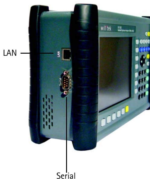
Figura 3 Conectores del 9100 en la parte izquierda del instrumento
