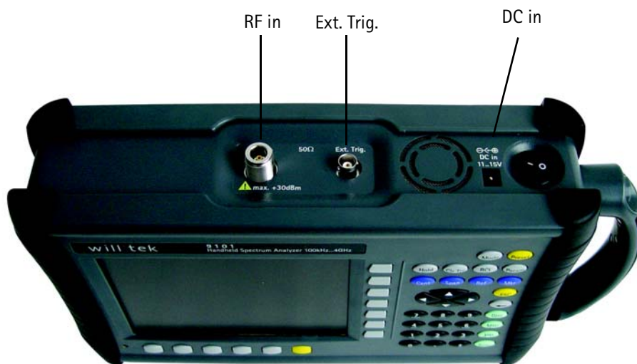
Figura 1 Conectores del 9101 en la parte superior del instrumento
