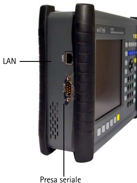
Figura 2 Connettori del 9102 sul fianco sinistro dell'apparecchio
