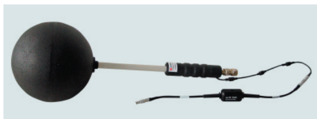
利用全向形天线更容易完成辐射测量
