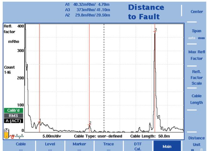
Detección y localización precisas de incluso los más mínimos fallos en los cables de la instalación mediante el modo DTF...
