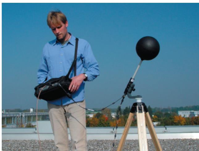
Medidas con el analizador de espectro portátil 9102 y la 9171 Isotropic Antenna
