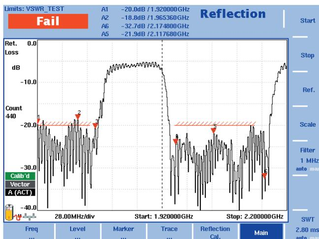
Utilizando líneas de límites, el sistema de antenas puede ser aceptado con una sola ojeada fijándonos en las pérdidas de retorno en los enlaces ascendente y descendente.
