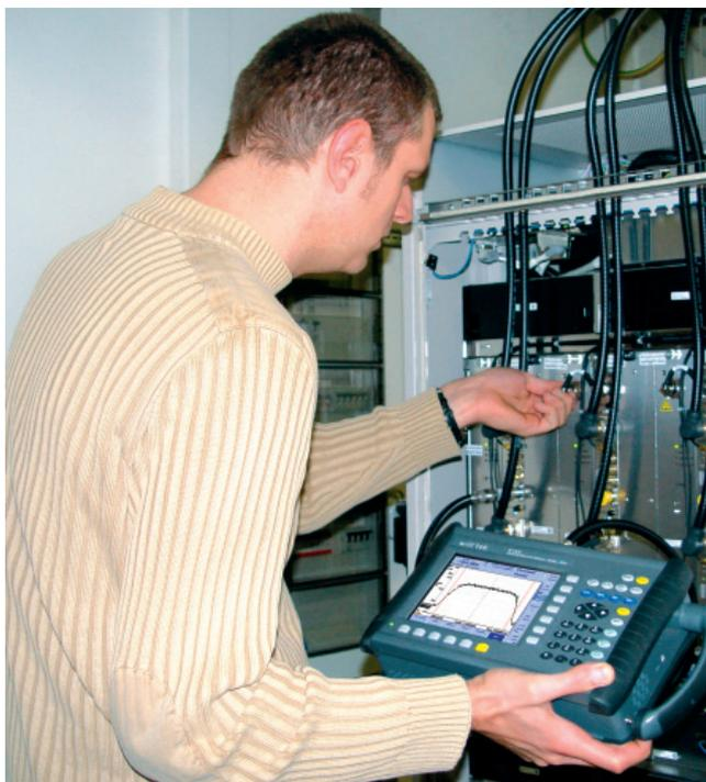
Medidas de potencia de canal en un UMTS Node B
