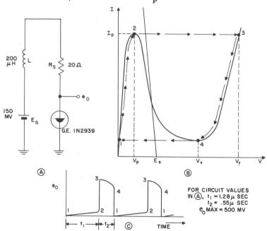
BASIC TUNNEL DIODE RELAXATION OSCILLATOR CIRCUIT
