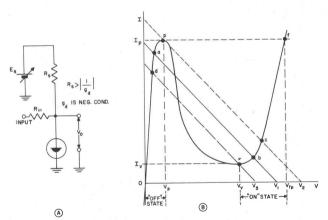
SIMPLE TUNNEL DIODE BISTABLE CIRCUIT
