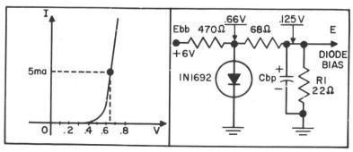
SILICON DIODE VOLTAGE REGULATOR
