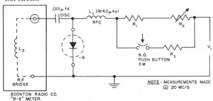
BASIC TUNNEL DIODE CAPACITANCE TEST CIRCUIT
